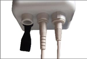
Avant l'utilisation, vérifier que la télécommande et le vérin sont correctement branchés au bloc de contrôle (page 25).
