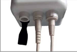
Avant l'utilisation, vérifier que la télécommande et le vérin sont correctement branchés au bloc de contrôle (page 22).
